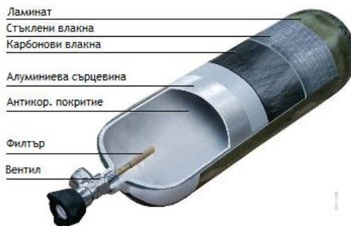
фиг.18 Устройство на композитна бутилка със сърцевина от алуминий.
