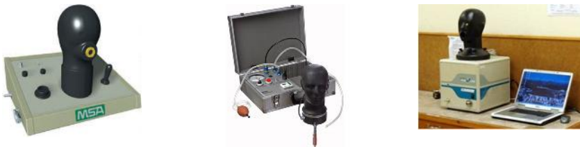
фиг.30 Стендове за тестване на целолицеви маски за ВДА
