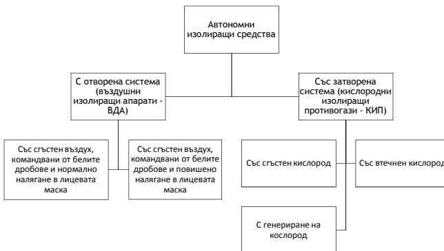
фиг.5 Класификация на автономните изолиращи средства
