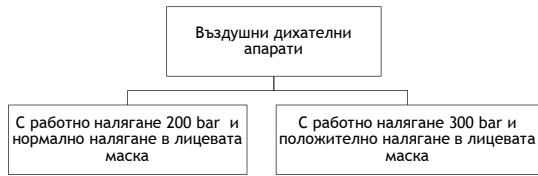
фиг.6 Видове автономни изолиращи въздушни дихателни апарати с отворена система
